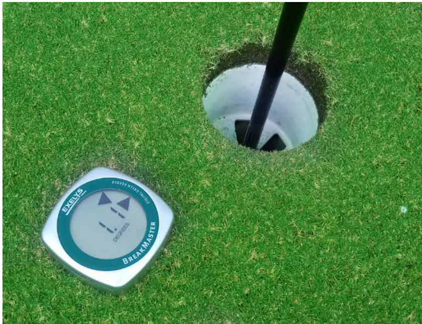
Alat BreakMaster menunjukkan angka 1,1 derajat , sehingga lokasi ini bisa dibuat lubang The BreakMaster tool shows the number 1.1 degrees, so this location can be made a hole
